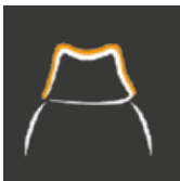
Grosor mínimo de la pared (sin revestimiento)
